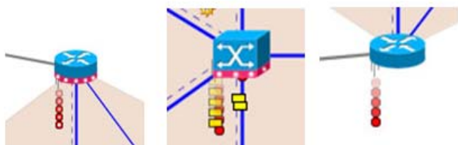
Figura 2. Descarte de paquetes diferentes a distintos tipos de tráfico.
