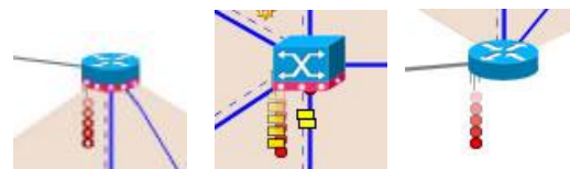
Figura 6: Descarte de paquetes pertenecientes a diferentes tipos de tráfico
