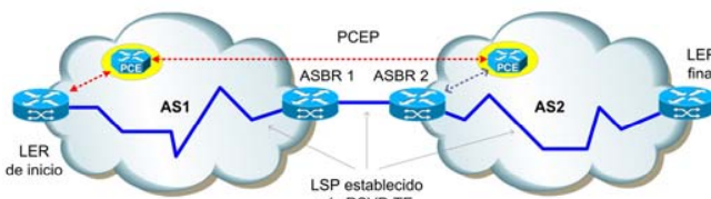
Fig. 14. Computación distribuida de LSP inter-AS mediante PCE.
